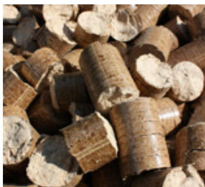
Pellets er sammenpresset flis og sagspon og er særlig egnet for mindre varmeanlegg.
